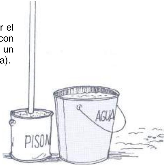
Si el suelo es arcilloso, o no permite compactación, se le echa material selecto, (piedra, tierra, arena). Esto se echa en capas de veinte centímetros y se apisona.
