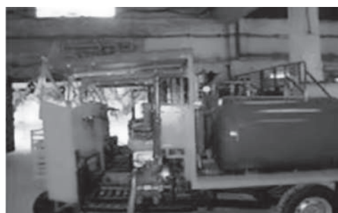
Triciclo con cisterna y bomba de succión portátil
